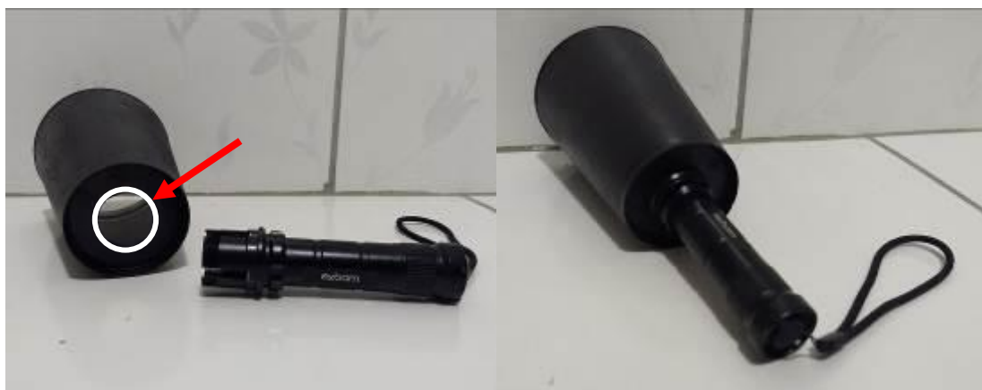
Figura 2: Furo feito no fundo do copo e encaixe da lanterna.
