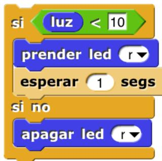
En este ejemplo, se ha utilizado el valor del sensor de luz, que está incorporado en la tarjeta Mini, para el operador de comparación.
