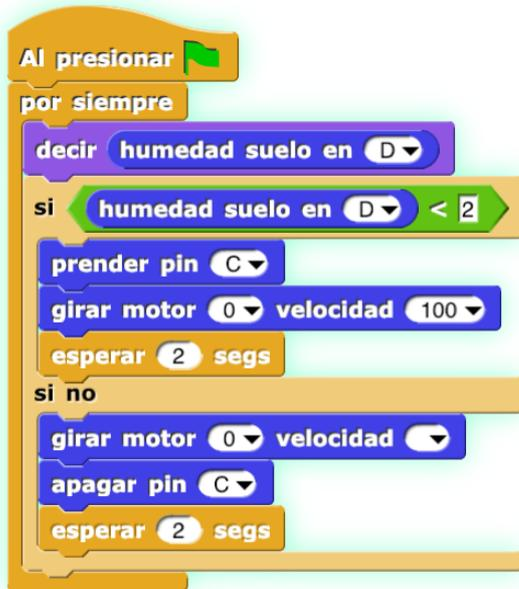
El pin "C" tiene conectado una pequeña bomba de agua de acuario que se activa si el sensor de humedad de suelo, conectado al pin "D" es menor a 2. En caso contrario, el motor se detiene.
