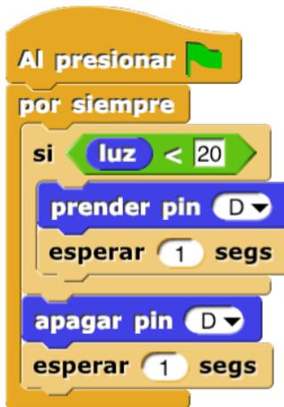
Algoritmo con actuador externo conectado en el pin “D” de la tarjeta Mini.
