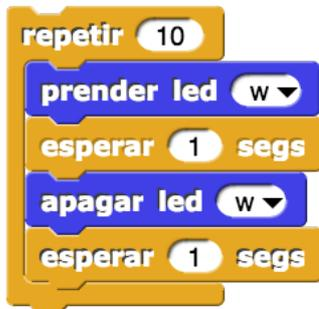
En el caso de las repeticiones, el ejemplo muestra un algoritmo que prende y apaga un led repetidamente, 10 veces.
